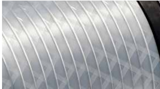
Aluminiumblankdraht flach, 2 x gegenläufig gewickelt mit SynTherm® P, 20 % Überlappung
