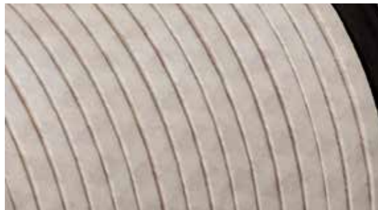
Kupferblankdraht flach, 2 x gegenläufig gewickelt mit SynTherm® YT510, 30 % Überlappung
